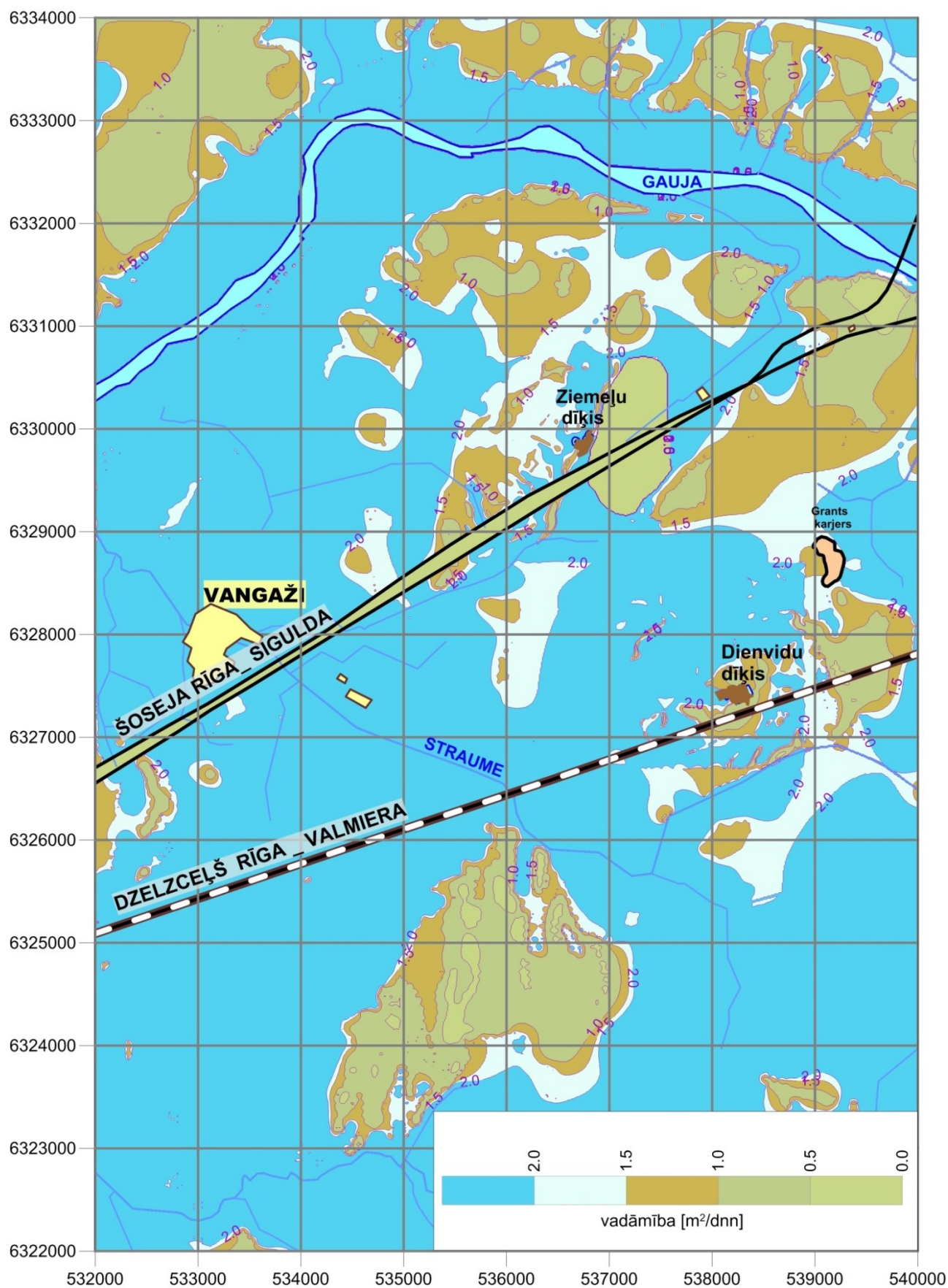
6.21. att. Aerācijas zonas aer vertikālo ūdens vadāmību kodola [m 2 /dnn] izolīnu karte (ūdens vadāmība=kodols×10 -4 )
